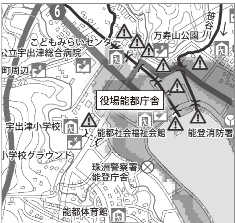
役場能都庁舎は浸水深が最も大きい区域内に位置しています。津波のシミュレーション結果では、2.0～5.0%。2階軒下までつかる深さが想定されています。
