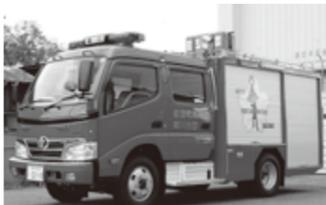
新しい車両は全長5.8m、乗車定員8人、放水能力毎分2,600ℓ、150馬力で、積雪寒冷地特殊機装されています。
