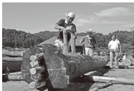
【クリ木半割実験】口径 60 ㍎、長さ 8.3 ㍎のクリ木の木口にくさびを打ち込み、割れ口を広げていく。ある程度広がったら横からくさびを打ち込んだ。所要時間 53 分 47 秒。
