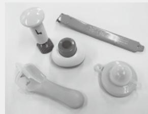
市販されている、安全・簡単にガス抜きができる穴開け器具の例
