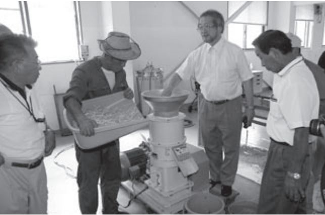
1時間で約50㌔のペレットを生産する製造機
