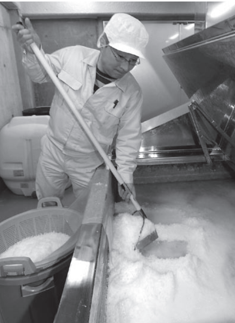
製塩装置から塩を取り出す豊原さん。煮詰めすぎると辛くなりすぎるので、濃度35%、約60 キログラム までの一番塩だけが製品化される。
