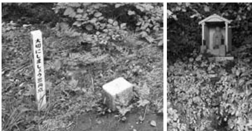
【写真左】鉢伏山頂上（543.6ミ）地点にある三角点には標識となる柱石が埋められている。緯度・経度・標高の基準点。
