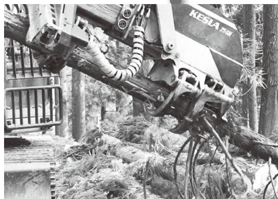
②枝払い 木を左右に動かし、長さを測り ながら、枝を切り落とす。
