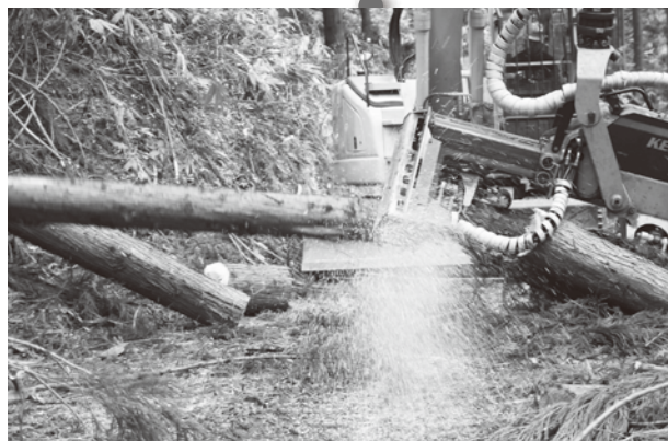
③玉伐り 枝を落とした木材を、一定の長さで切り落とす。
