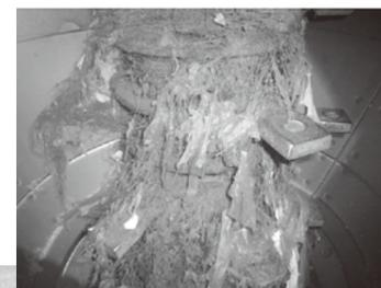
漁網が絡まって停止し、ごみ処理に支障をきたしている破砕機
