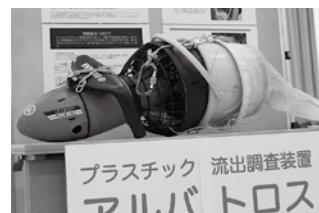
水中スクータを改良して作られた調査装置「アルバトロス」。まずは調査を行い、海洋ゴミの実態を把握
