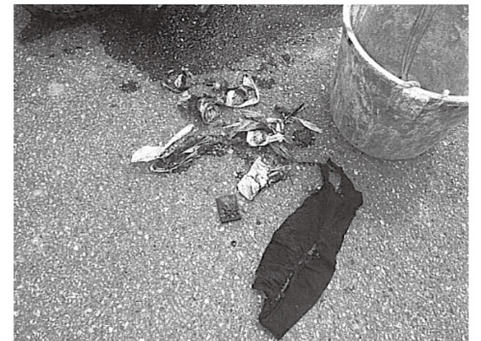
ポンプから取り出された異物
