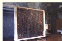
加熱30分経過後、外側加熱面は900℃を超えるが、燃え抜けない
